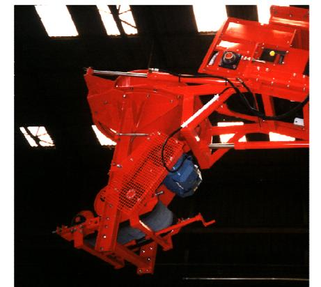
Cette option est montée en extrémité basse d'un tube de descente. La rotation sur 360° est assurée par moteur hydraulique et le réglage vertical du projecteur, par vérin hydraulique.
