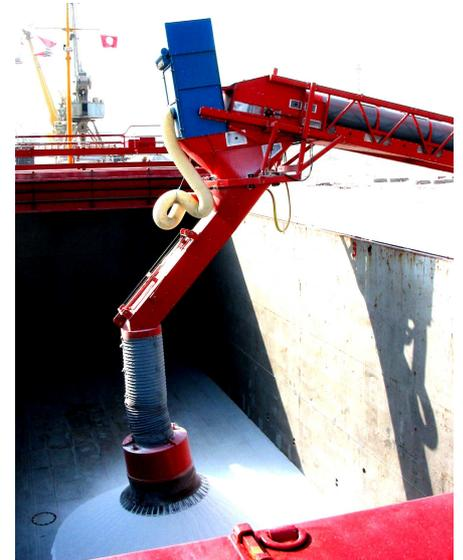
Cette option impose le raccordement avec un filtre dont la taille dépend du débit à assurer et du niveau de poussières émis par le produit.
