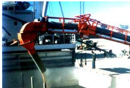
La hauteur de chute est réduite ce qui limite les bris de produit et la poussière. Cela permet aussi d'améliorer la surface de répartition dans les cales des bateaux.
