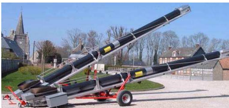
Le cas échéant la structure de la sauterelle peut-être du type treillis autoportant à croisillons pour supporter des poids importants en porte-à-faux situés en bout de convoyeur. Du type projeteur.
